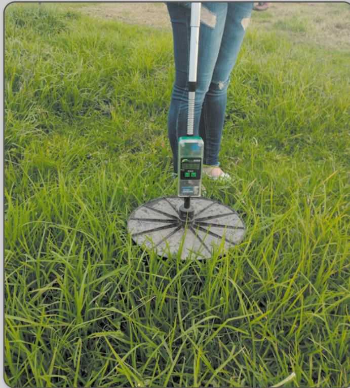
Figura 41 – Prato ascendente utilizado para estimativa indireta da massa de forragem.
