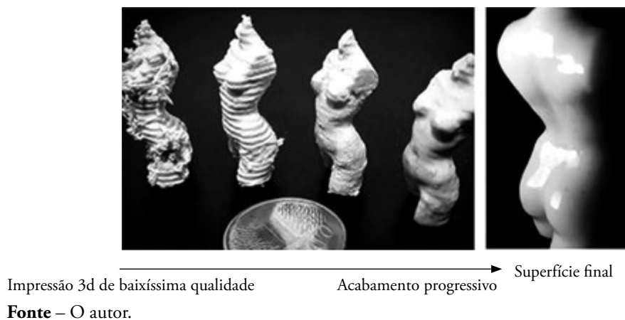
Figura 8 – Exemplo de técnicas de acabamento progressivas de objetos de impressão 3D sobre impressão 3D de baixíssima qualidade.
