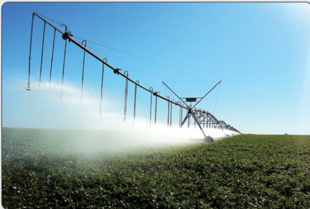
Figura 21 – Irrigação mecanizada do tipo pivô central na cultura do feijoeiro.
