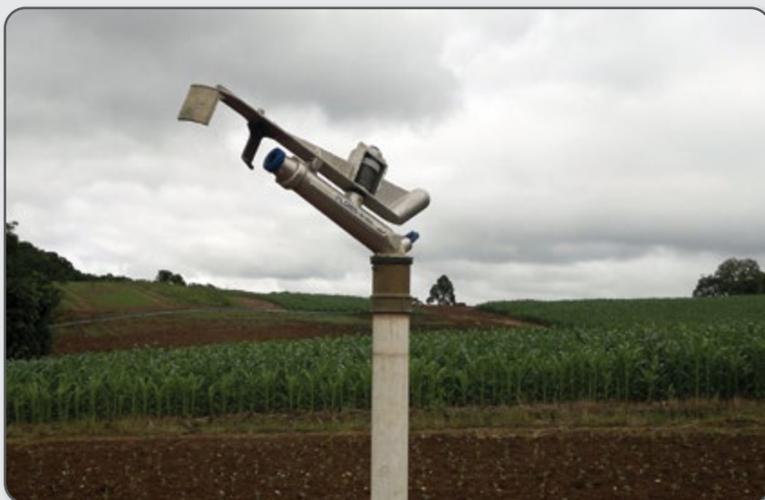
Figura 11 – Exemplos de aspersores utilizados no sistema de irrigação por aspersão convencional.
