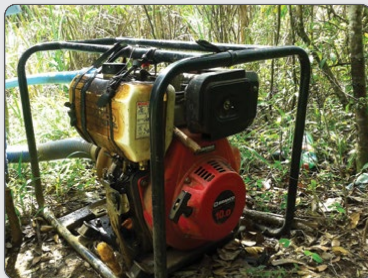
Figura 13 – Exemplo de um conjunto motobomba a diesel .
