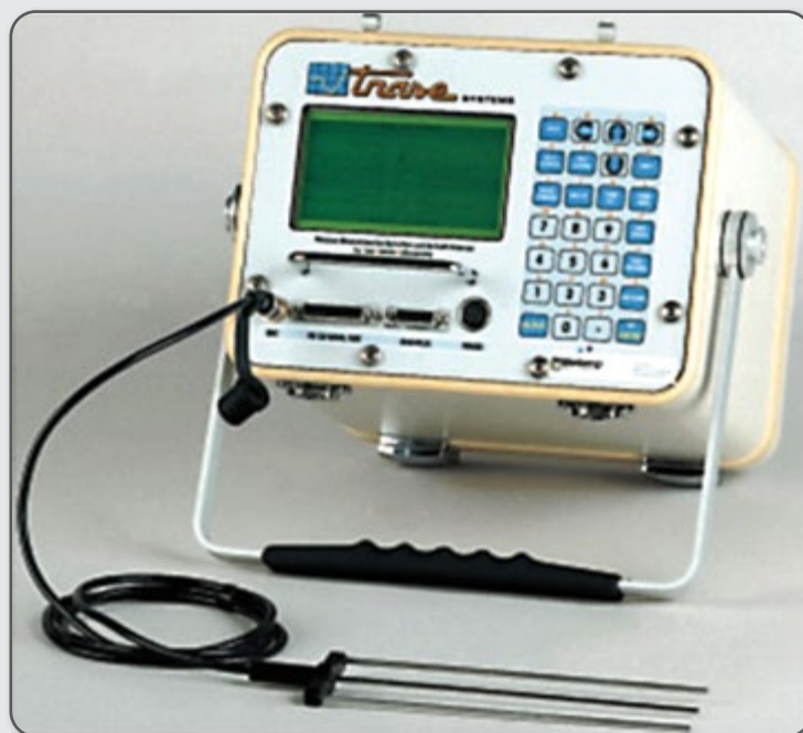
Figura 39 – Equipamento TDR com hastes.
