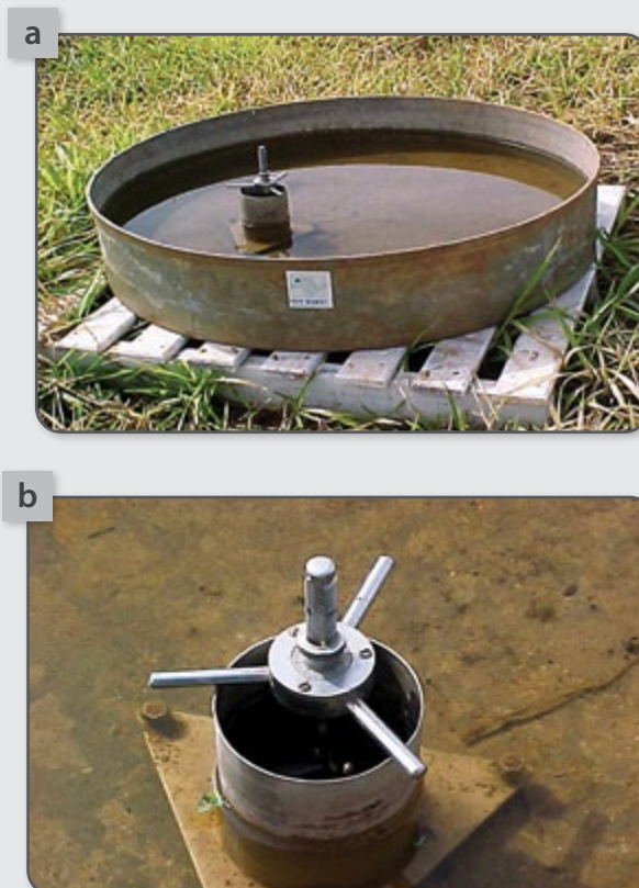
Figura 36 – Imagem do tanque classe A para monitoramento da evaporação da água.
