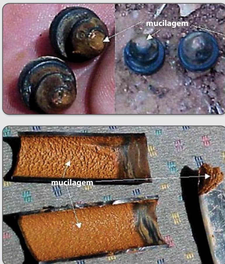
Figura 9 – Imagem de emissores (gotejadores) de irrigação localizada entupidos.
