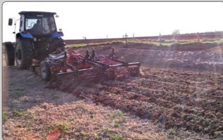
Figura 7 – Passagem de escarificador-destorroador.
