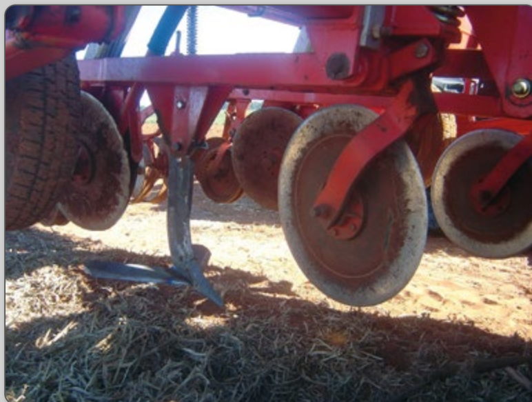
Figura 9 – Kit para plantio direto mecanizado.
