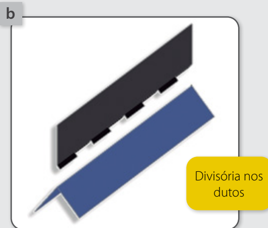
Figura 23 – Vista de uma seção da torre (a) e detalhe dos dutos com divisórias (b).
