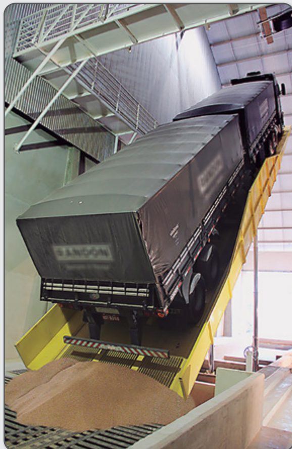
Figura 14 – Caminhão no ato da descarga em plataforma basculante.
