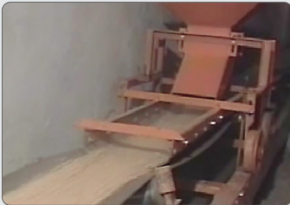
Figura 83 – Tremonha de carga móvel em operação.
