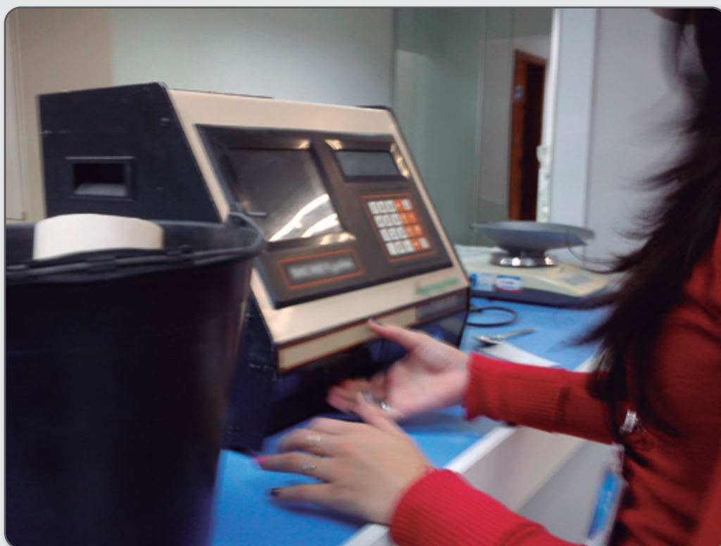
Figura 15 – Operação de determinação do teor de umidade de uma amostra de grãos.
