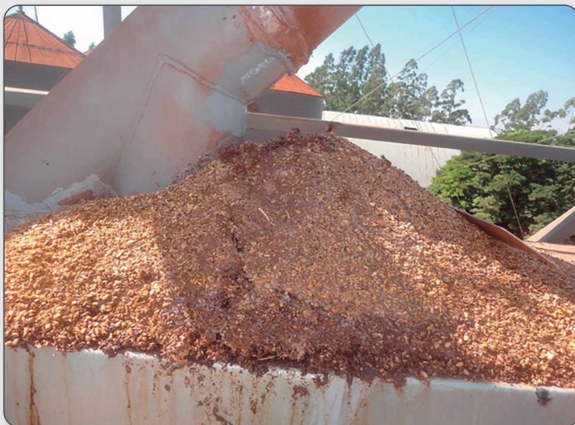
Figura 51 – Vazamento em amortecedor final.
