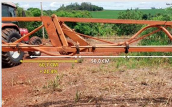
Distância incorreta entre bicos (destacado em amarelo), indicando a necessidade de encurtamento da mangueira
