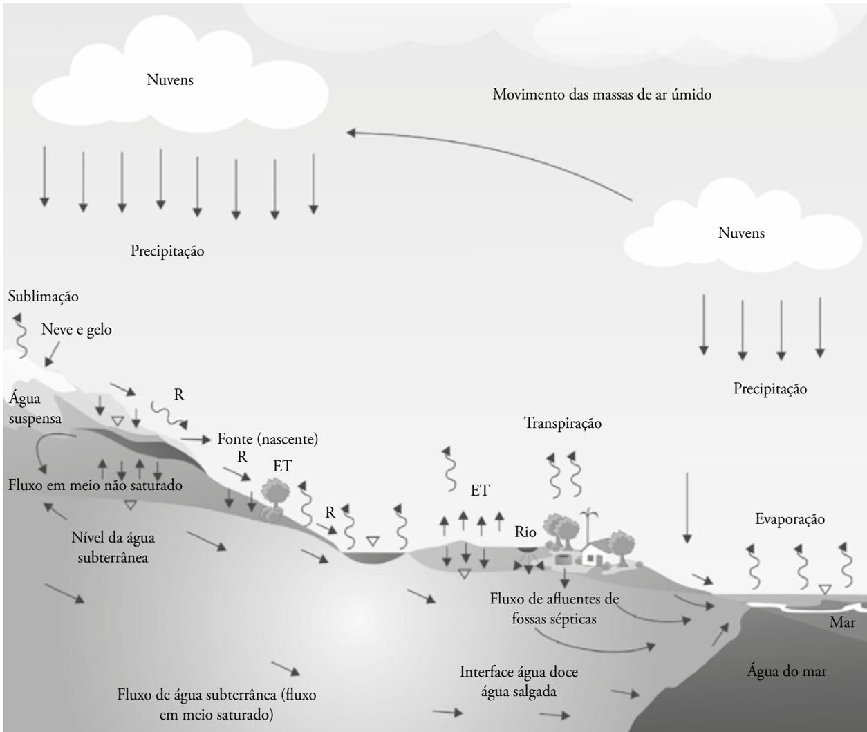
E: evaporação; ET: evapotranspiração; I: infiltração; R: escoamento superficial.
