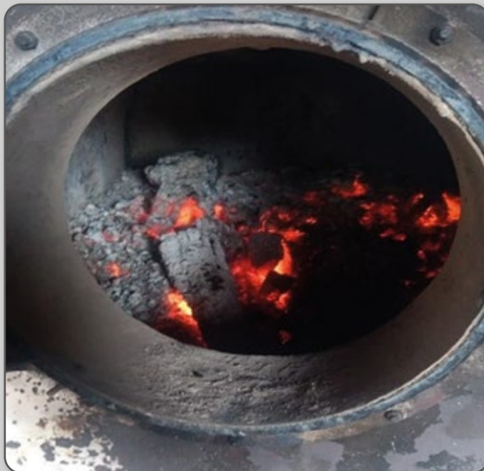
Figura 15 – Fornalha cheia de cinzas prejudicando a eficiência do forno.
