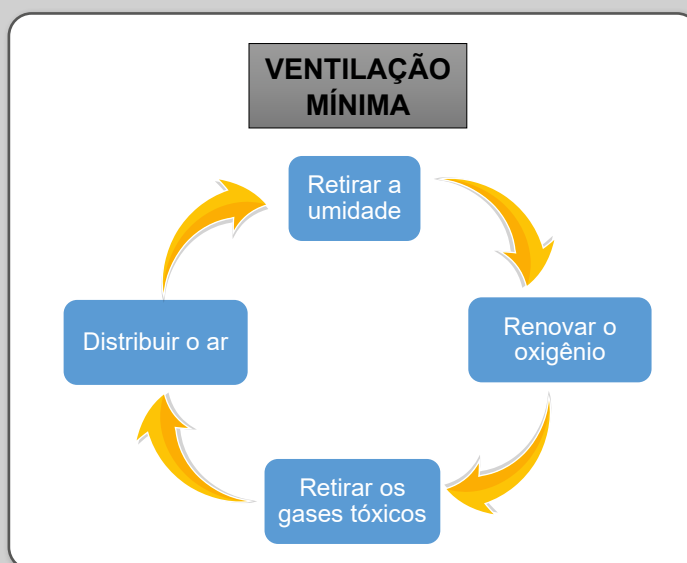
Figura 20 – Função da ventilação mínima.
