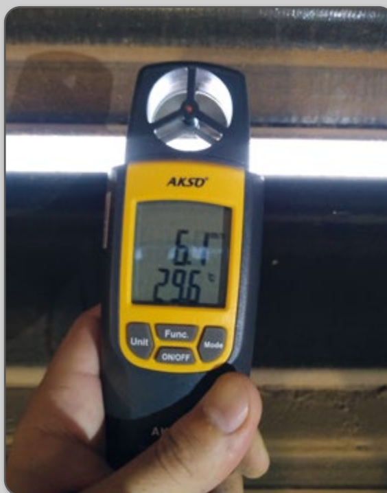
Figura 25 – Velocidade do ar na entrada do inlet avaliada com auxílio de um anemômetro, equipamento utilizado para medir a velocidade do vento.
