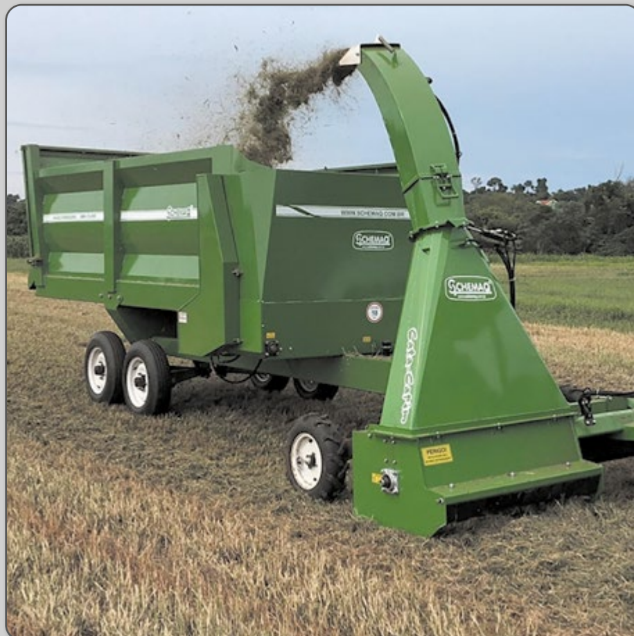
Figura 3 – Colhedora de forragens de corte simples em operação.
