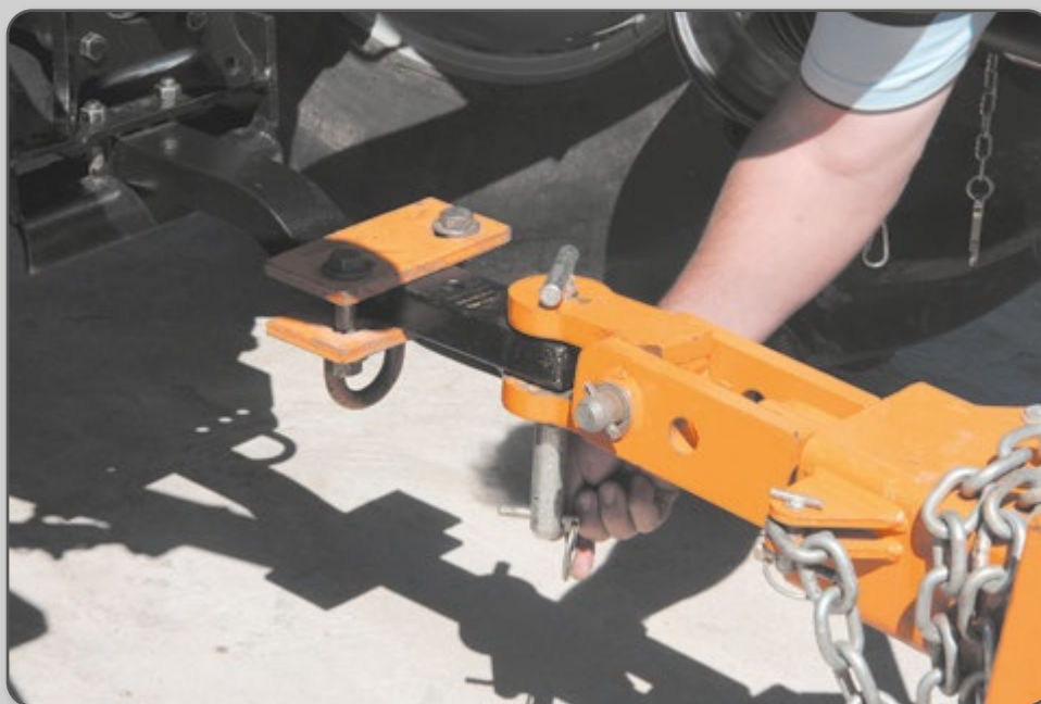
Figura 35 – Engate do cabeçalho do equipamento com a barra de tração do trator.
