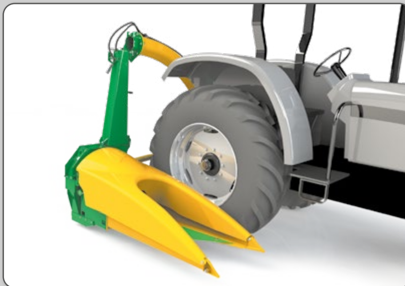
Figura 10 – Colhedora de forragens de linha simples acoplada ao trator.
