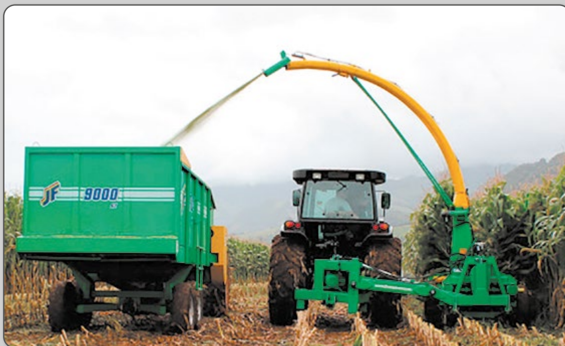
Figura 2 – Colhedora de forragens de precisão de 2 linhas acoplada ao SH3P do trator.
