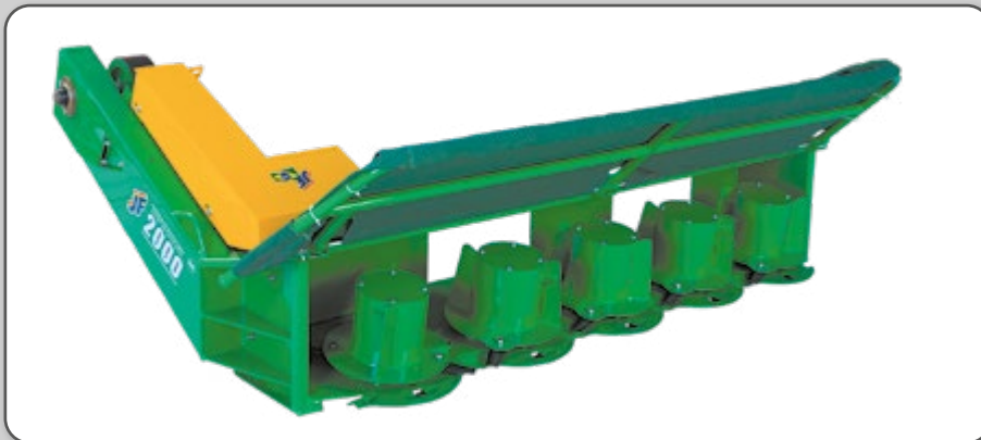
Figura 13 – Plataforma de tambor para corte de capim.
