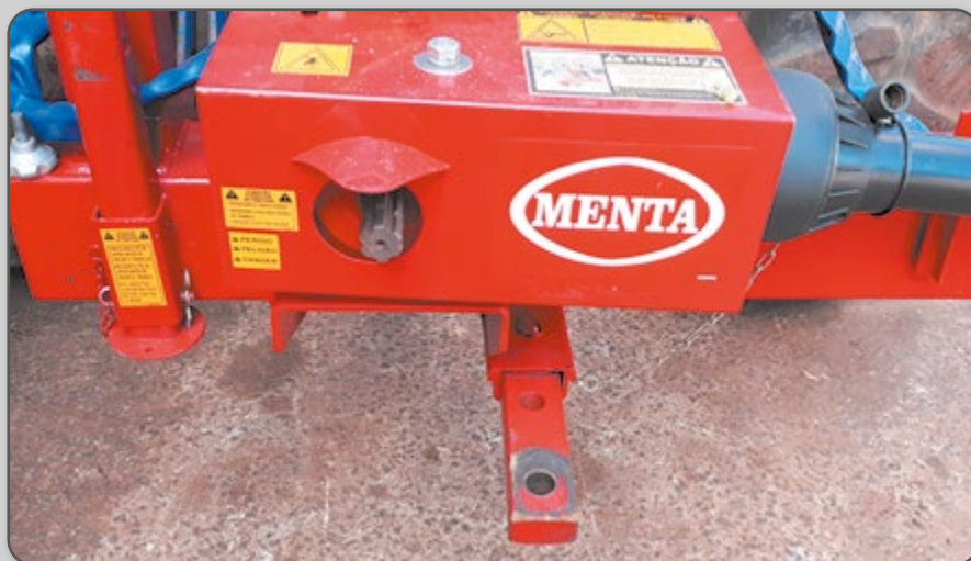
Figura 30 – Ponto de engate do veículo de transporte na colhedora de forragens.
