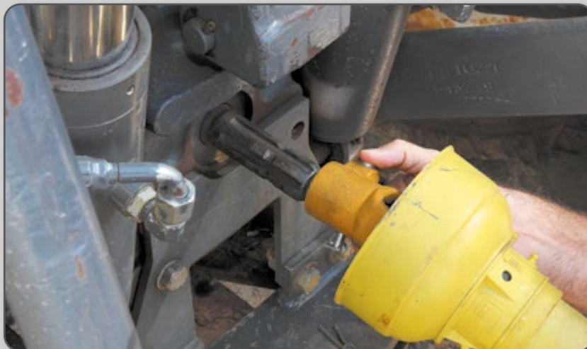
Figura 40 – Acoplamento do eixo cardã à tdp do trator.
