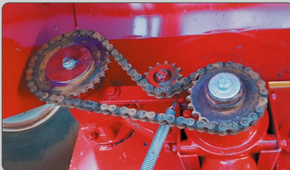
Figura 22 – Correntes para regulação do tamanho das partículas.
