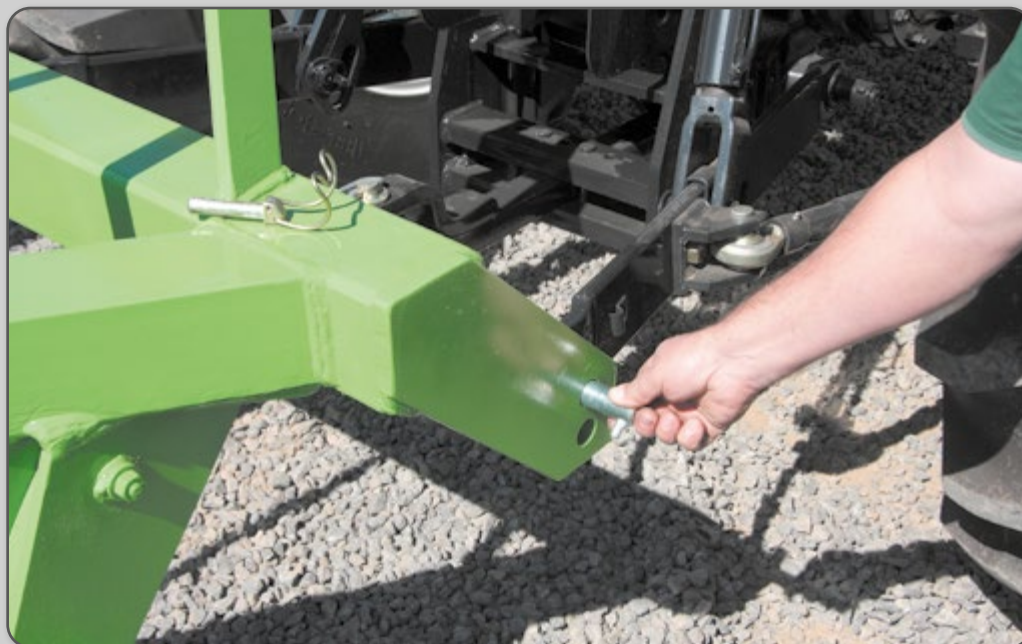
Figura 34 – Acoplamento do braço de levante inferior direito.
