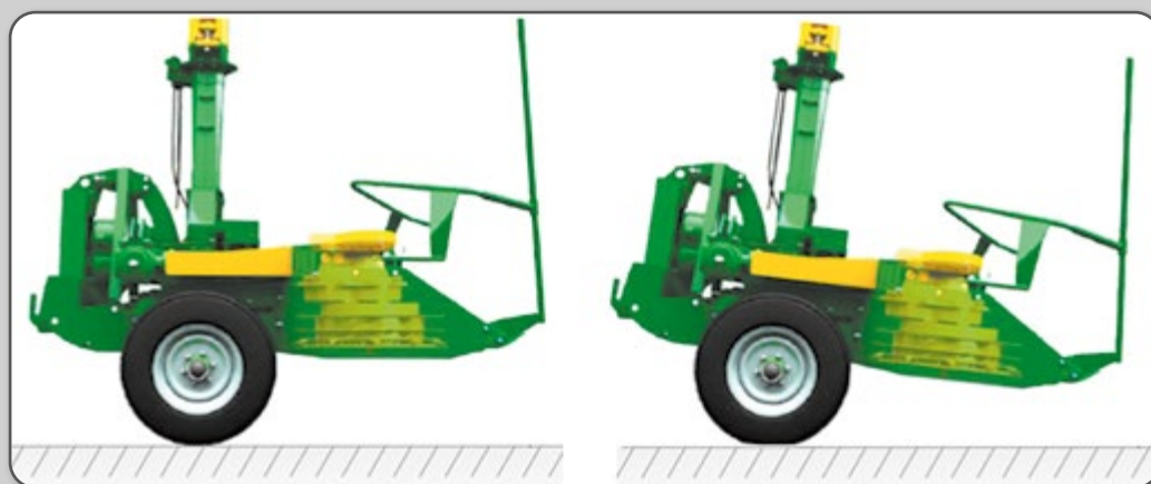
Figura 38 – Colhedora de forragens nivelada na esquerda e inclinada para frente na direita.
