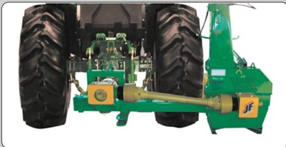
Figura 37 – Colhedora de forragens acoplada no trator e nivelada transversalmente.
