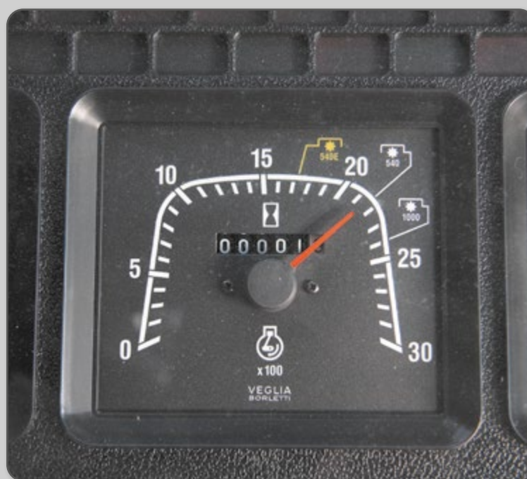
Figura 42 – Painel do trator com diferentes possibilidades de rotação da TDP.
