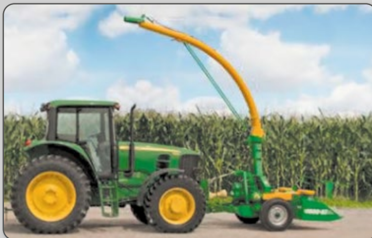
Figura 51 – Conjunto trator e colhedora de forragens acoplada no SH3P frontal.
