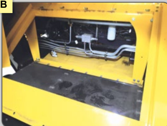
Figura 10 – Abertura de coberturas e tampas para remoção de grãos e partes de plantas acumuladas.
