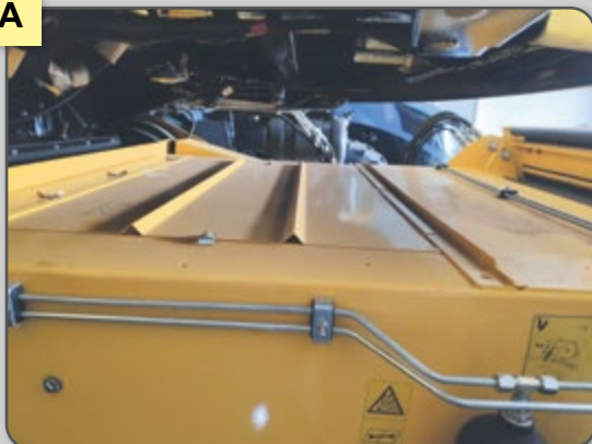
Figura 3 – Abertura de tampas e coberturas para iniciar o processo de remoção de grãos e limpeza.
