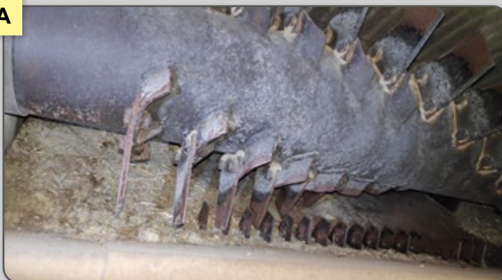
Figura 16 – Limpeza de resíduos acumulados na região do picador (a) e espalhador (b).
