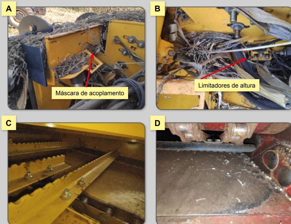
Figura 14 – Acúmulo de plantas/sementes no canal alimentador e componentes.
