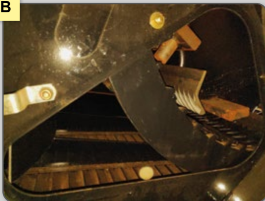
Figura 15 – Limpeza externa da máquina, acessando gaiola do rotor/região dos cilindros.
