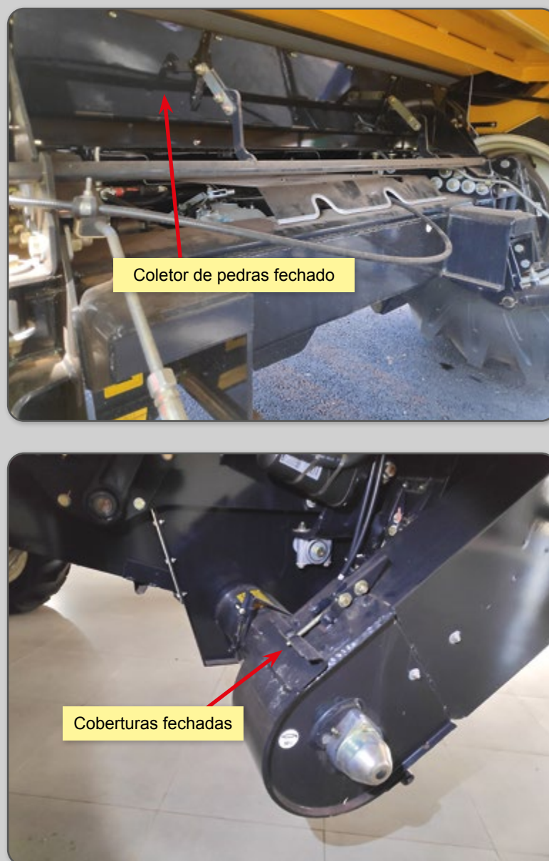
Figura 8 – Fechamento do coletor de pedras após o processo de limpeza da colhedora.
