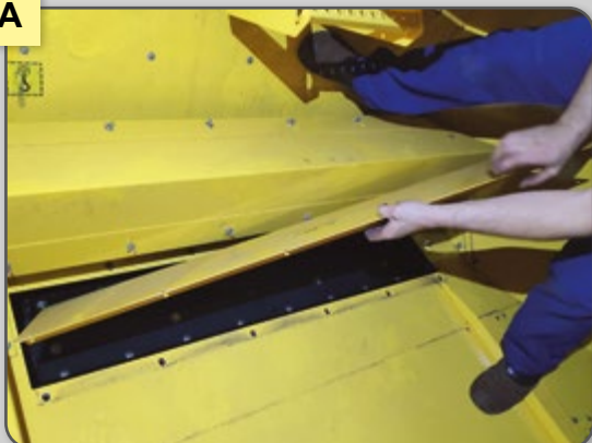
Figura 10 – Abertura de coberturas e tampas para remoção de grãos e partes de plantas acumuladas.
