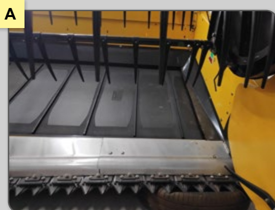
Figura 12 – Pontos de limpeza da plataforma: esteira (a), laterais da plataforma (b), sem-fim plataforma (c), correntes de transporte (d), barra de corte (e), mangueiras e componentes (f).
