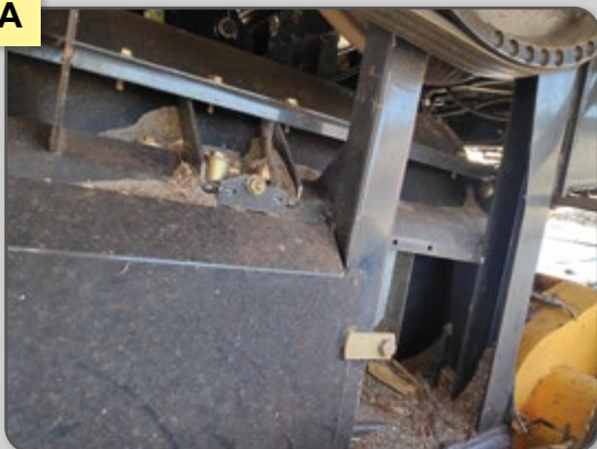
Figura 15 – Limpeza externa da máquina, acessando gaiola do rotor/região dos cilindros.
