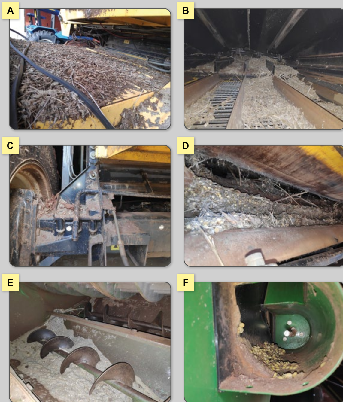
Figura 6 – Máquinas com problemas de limpeza devido ao acúmulo excessivo de plantas e sementes. Acúmulo sobre o alimentador (a), as peneiras (b), os eixos (c), o coletor de pedras (d), o sem-fim de separação (e) e o sem-fim de retilha (f).
