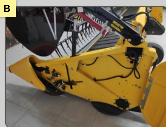
Figura 12 – Pontos de limpeza da plataforma: esteira (a), laterais da plataforma (b), sem-fim plataforma (c), correntes de transporte (d), barra de corte (e), mangueiras e componentes (f).
