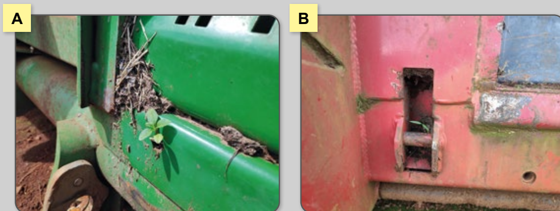
Figura 13 – Plataformas desacopladas, com presença de plantas daninhas germinadas em locais que apresentam acúmulo de resíduos (a) e solo (b).
