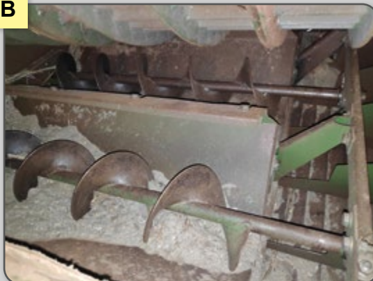
Figura 17 – Limpeza interna, acessando região das peneiras (c), bandeijão (a, b), ventilador e eixos sem-fim de grãos limpos e de retrilha (e).
