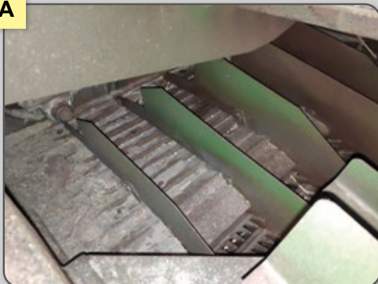
Figura 17 – Limpeza interna, acessando região das peneiras (c), bandeijão (a, b), ventilador e eixos sem-fim de grãos limpos e de retrilha (e).
