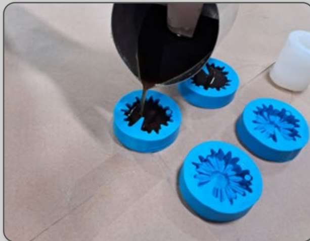
Figura 60 – Transferência da cera de abelha para os moldes de silicone.
