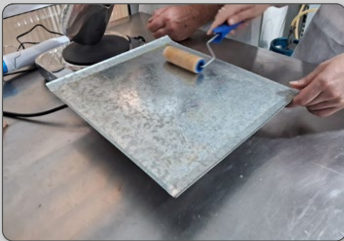
Figura 86 – Placa de metal em aquecimento para incrustação dos panos.
