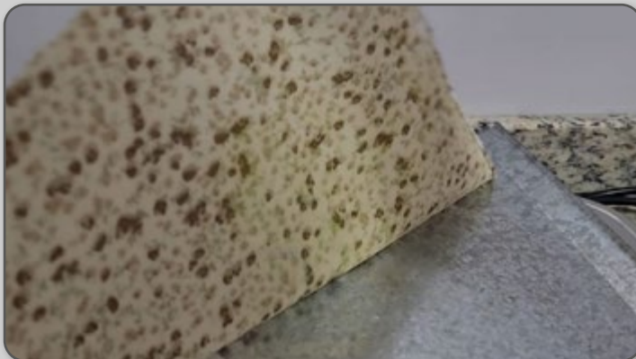
Figura 89 – Retirada do pano encerado após a incrustação com as ceras e a resina.
