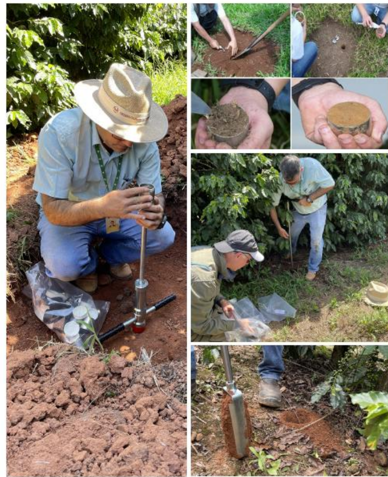
Figura 3: Coleta de amostras de solo com estrutura preservada (amostras indeformadas) e estrutura não preservada (amostras deformadas) utilizando amostrador de solo e trado holandês.
