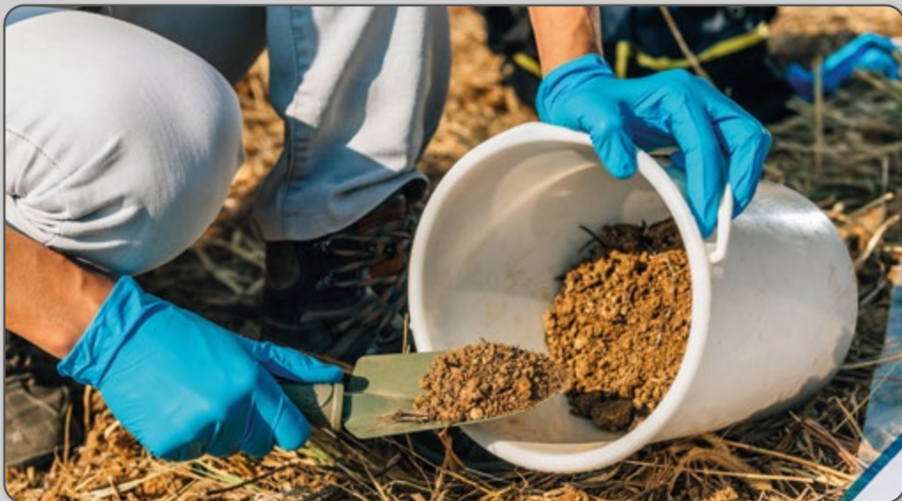
Figura 9 – Obtenção da amostra composta.
