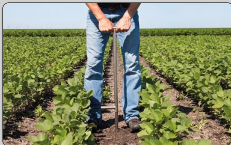
Figura 7 – Movimento para retirada do trado do solo.
