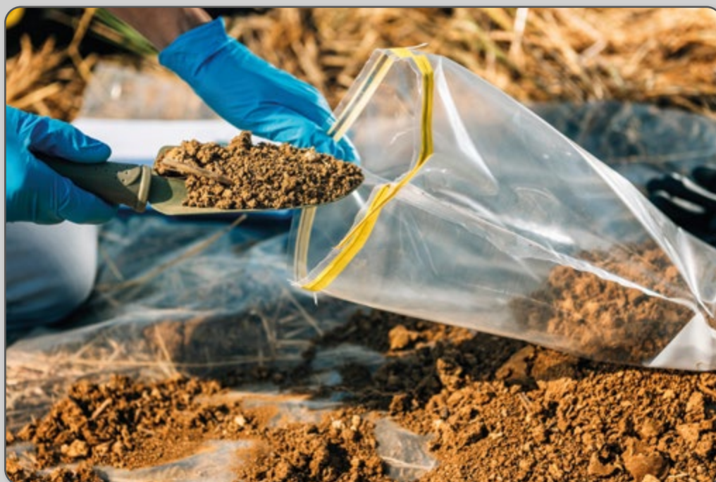
Figura 10 – Montagem da amostra com cerca de 500g.
