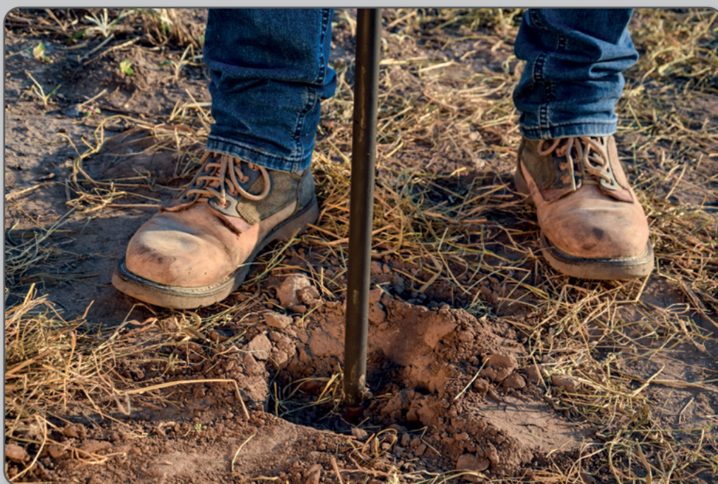
Figura 5 – Profundidade adequada para inserção do trado no solo.
