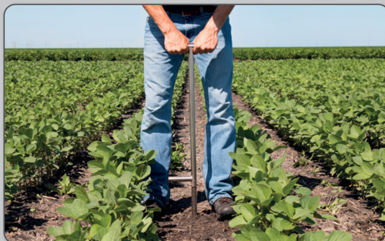
Figura 7 – Movimento para retirada do trado do solo.
