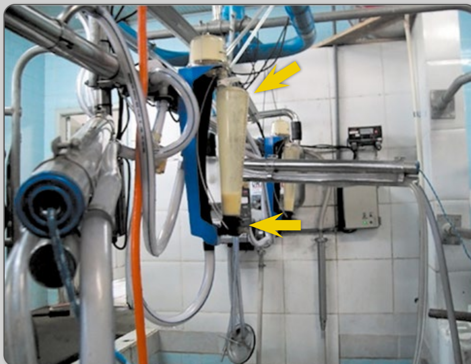
Figura 7 – Coleta de amostras de leite através do coletor automático individual por animal. Setas indicando a válvula para entrada de ar para homogeneização do leite e outra indicando o local para coleta de leite.
