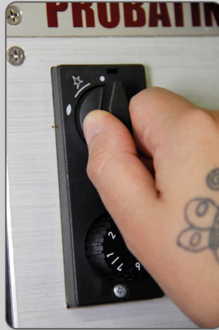
Figura 18 – Acionamento da ignição da chama.
