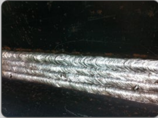
Figura 21 – Solda realizada adequadamente.
