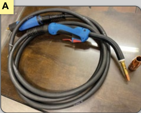
Figura 13 – Equipamentos e consumível tocha MIG. Tocha MIG (a); Bico contato (b); Conduíte (c); Porta-bico (d); Conjunto completo e bocal MIG (e) e Tocha padrão Euro Conector (f).
