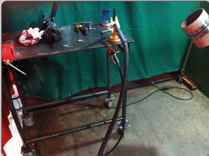
Figura 12 – Bancada com ferramentas e materiais para trabalhos de soldagem.
