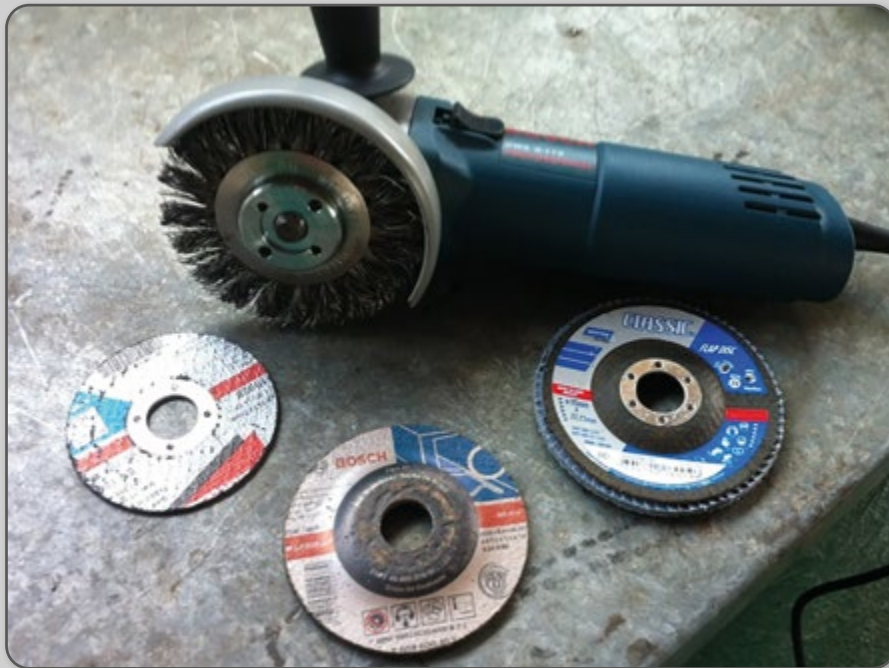
Figura 16 – Esmerilhadeira e discos abrasivos, indicados para a limpeza das peças a soldar.
