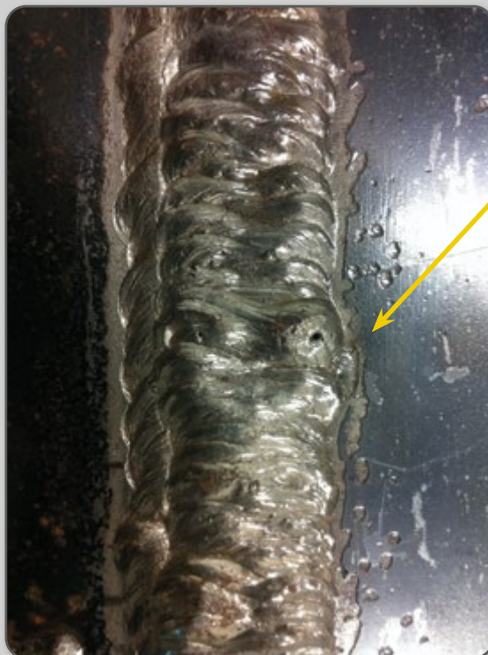
Figura 18 – Solda apresentando o defeito de poros.
