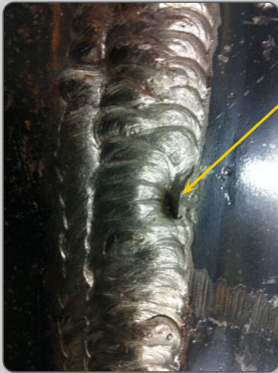
Figura 19 – Solda apresentando o defeito de deposição insuficiente.
