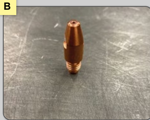
Figura 13 – Equipamentos e consumível tocha MIG. Tocha MIG (a); Bico contato (b); Conduíte (c); Porta-bico (d); Conjunto completo e bocal MIG (e) e Tocha padrão Euro Conector (f).
