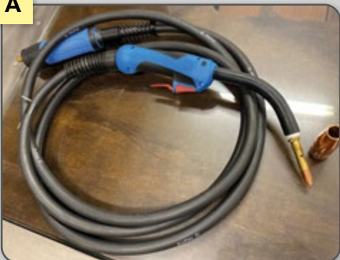
Figura 13 – Equipamentos e consumível tocha MIG. Tocha MIG (a); Bico contato (b); Conduíte (c); Porta-bico (d); Conjunto completo e bocal MIG (e) e Tocha padrão Euro Conector (f).
