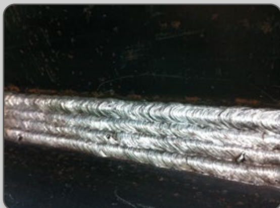
Figura 21 – Solda realizada adequadamente.
