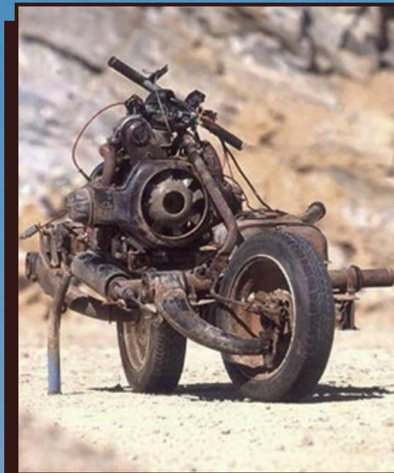
Durante dez dias, com sol escaldante e noites geladas, ele desmontou peça por peça do carro e reconstruiu uma espécie de motocicleta improvisada. Colocou o motor e a caixa de câmbio para o centro do chassi encurtado, montou duas rodas em um único eixo e adaptou um banco. Tudo isso sem eletricidade ou ferramentas adequadas. Quando terminou, ele tinha apenas meio litro de água. Eis que a máquina improvisada funcionou para alívio de Leray.
