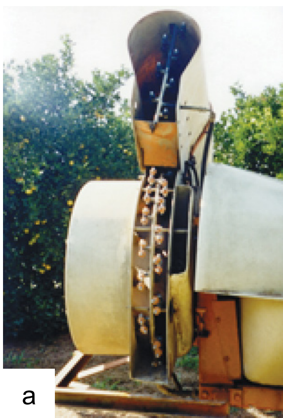
Figura 15 – Aumento do número de bicos na barra por meio do uso de duplicadores (a) ou pela utilização de barra com maior número de bicos (b).
