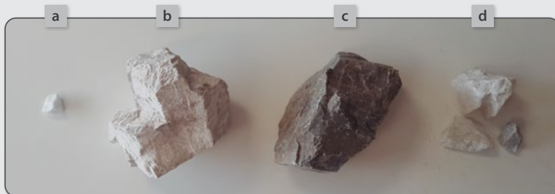
Figura 32 – O mineral calcita ( \text{CaCO}_3 ) (a) passa pelo processo de diagênese com cimentação formando a rocha sedimentar calcário ( \text{CaCO}_3 ), seja dolomítico (b) ou calcítico (c). Sob metamorfismo de contato, a temperatura aumenta, formando a rocha metamórfica mármore ( \text{CaCO}_3 ) (d).
