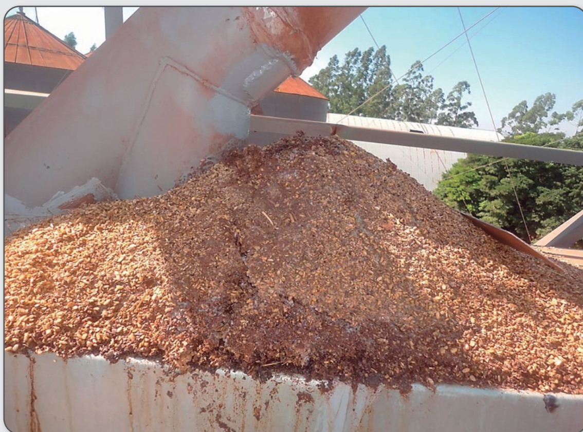
Figura 51 – Vazamento em amortecedor final.
