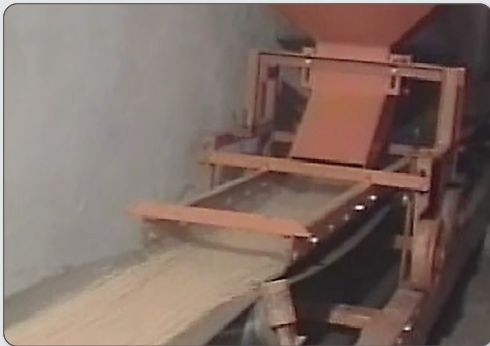
Figura 83 – Tremonha de carga móvel em operação.
