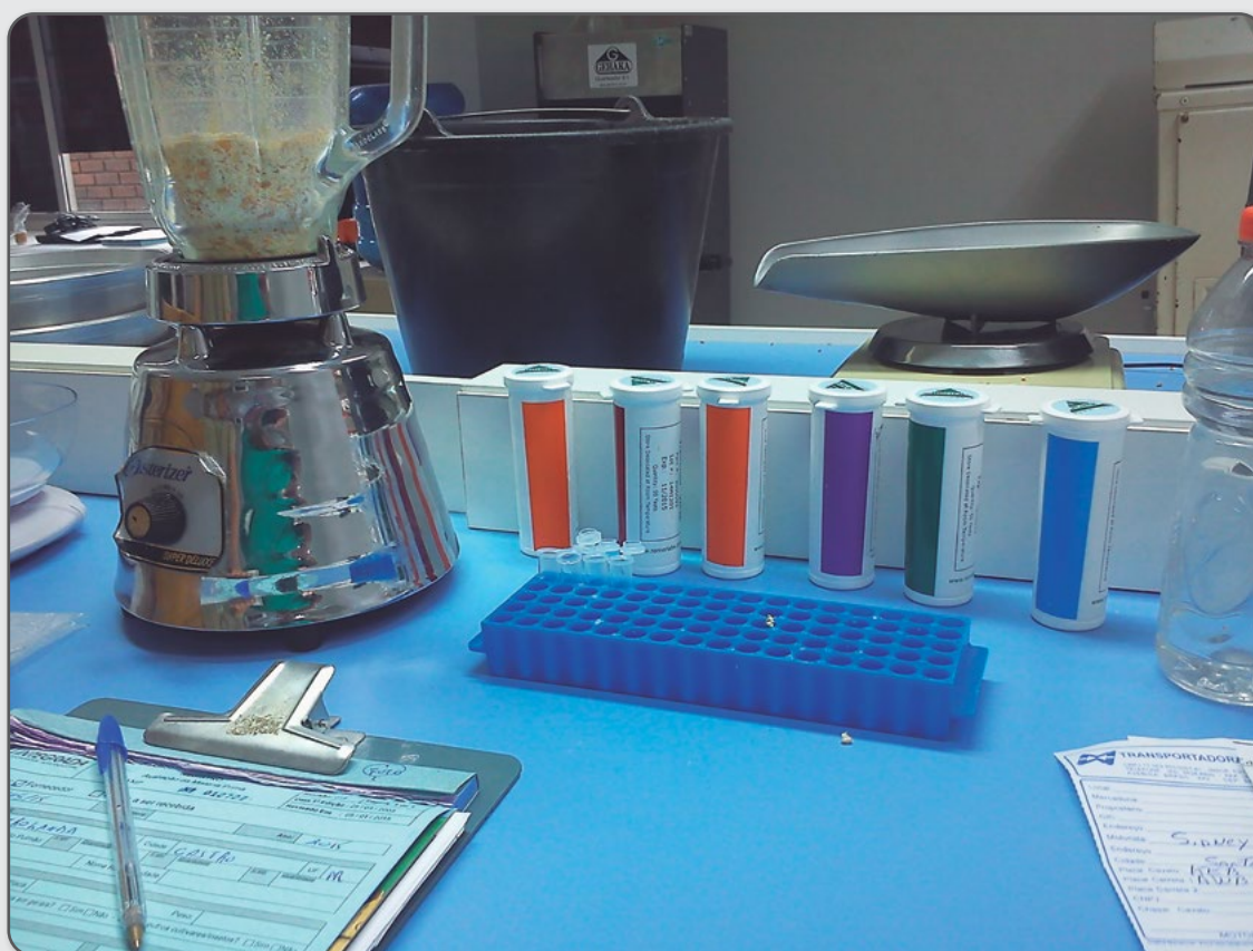
Figura 20 – Instrumentos e reagentes utilizados para identificação da presença de grãos geneticamente modificados (transgênicos) em uma amostra.
