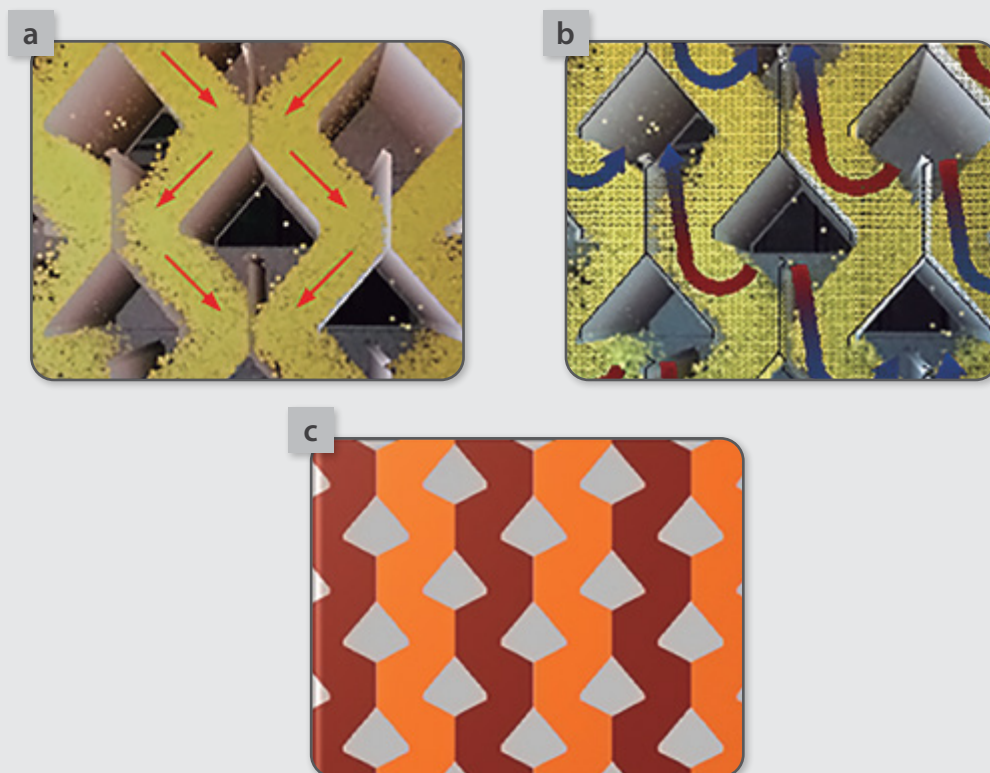
Figura 17 – Vista da torre de secagem do secador "Khronos" mostrando fluxos de grãos (a); fluxo do ar (b); e as "colunas" de grãos independentes (c).
