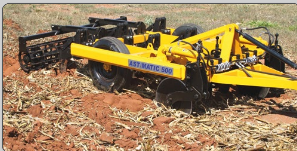
Figura 28 – Escarificador preparando o solo.
