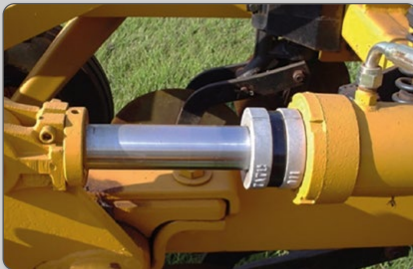
Figura 38 – Anel para controle da profundidade das hastes/ponteiras no escarificador.
