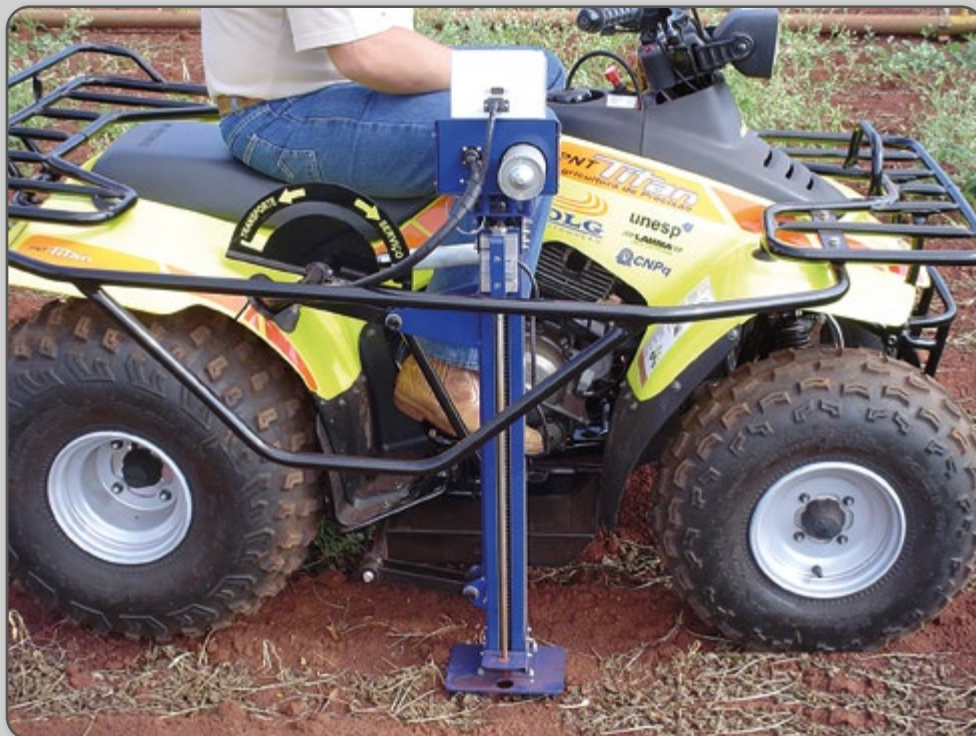
Figura 21 – Penetrógrafo acoplado a um quadriciclo.
