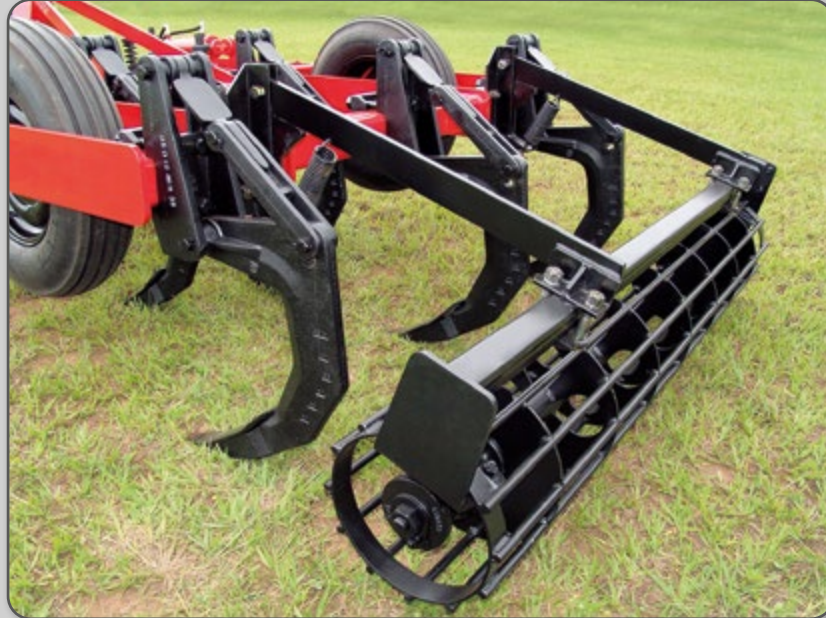
Figura 40 – Rolo destorroador/nivelador do escarificador.
