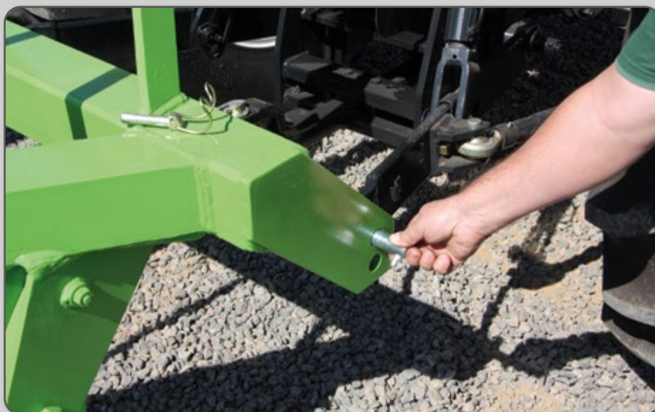
Figura 44 – Acoplamento do braço de levante inferior direito.
