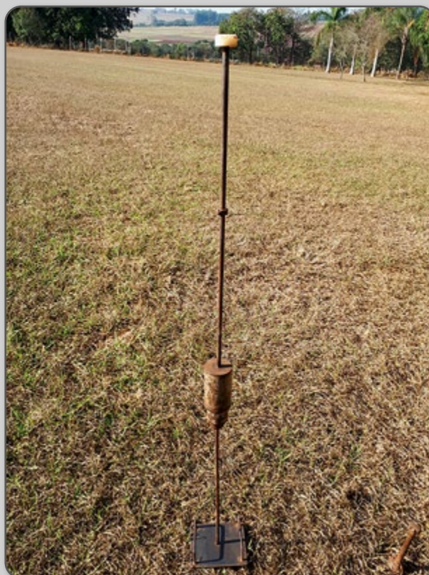
Figura 19 – Penetrômetro de impacto.
