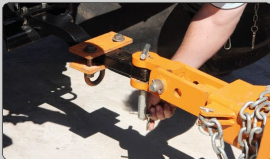
Figura 45 – Engate do cabeçalho do equipamento com a barra de tração do trator.
