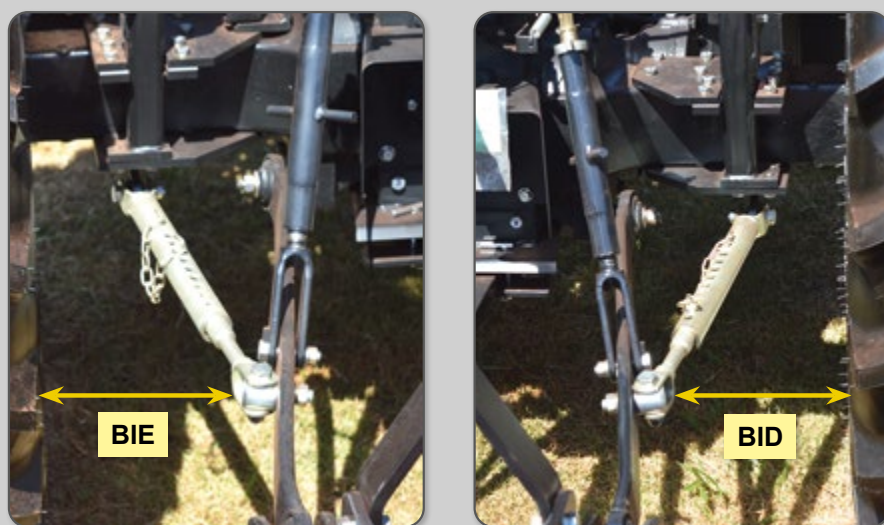
Figura 46 – Medição da distância dos braços de levante inferiores ao rodado.
