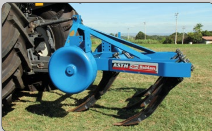
Figura 27 – Implemento montado no SH3P do trator.
