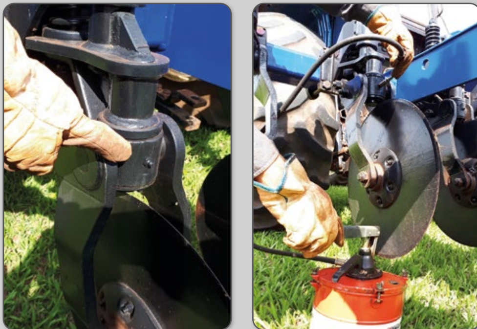
Figura 62 – Lubrificação do pino graxeiro do suporte do disco de corte.
