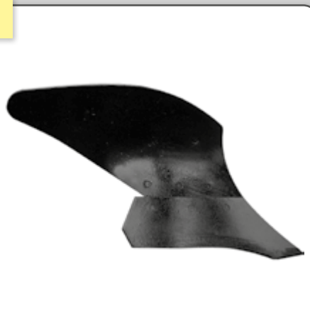
Figura 25 – Exemplos de ferramentas (órgãos ativos): A) Ponteira, B) Aiveca e C) Disco.
