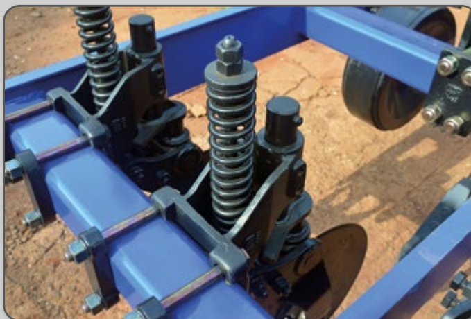
Figura 58 – Parafuso e porca para regulagem da pressão da mola no disco.
