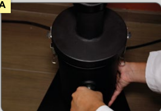
Figura 20 – a) Remoção do coletor de películas; b) Películas que se desgrudaram da semente durante as torras anteriores.
