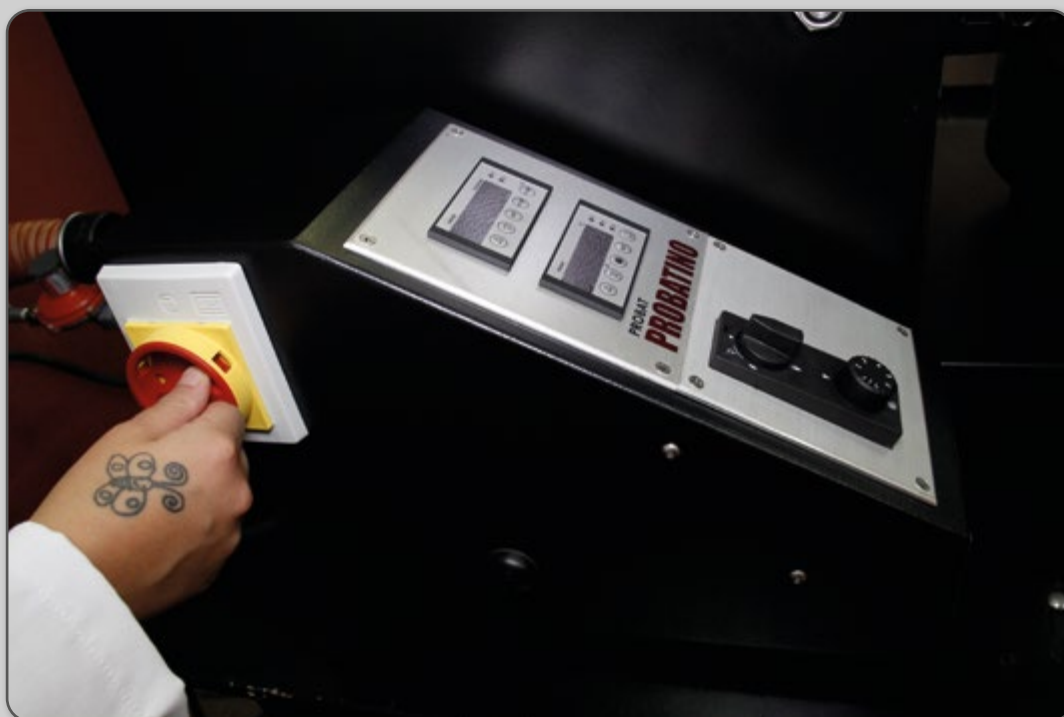
Figura 17 – Chave-geral do torrador.
