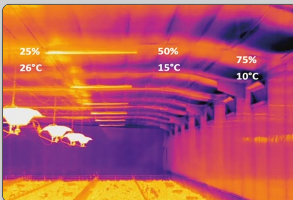
Figura 51 – Imagem termográfica de uma área de alojamento aquecida demonstrando a temperatura e a umidade do ar na passagem pelo Inlet .
