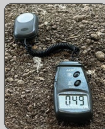
Figura 85 –Luxímetro posicionado no intervalo entre lâmpadas demonstrando a iluminância do galpão.
