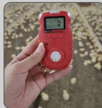
Figura 92 – Medidor de amônia posicionado ao fim da área alojada.
