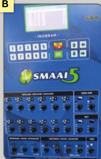
Figura 42 – Controladores de ambiente: A) PLASSON; B) INOBRAN; C) Chore-Time; D) GSI.
