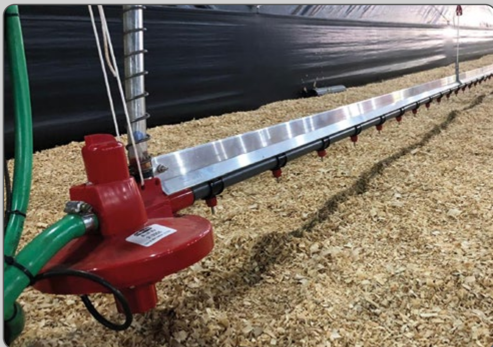
Figura 79 – Sistema de bebedouro tipo nipple .
