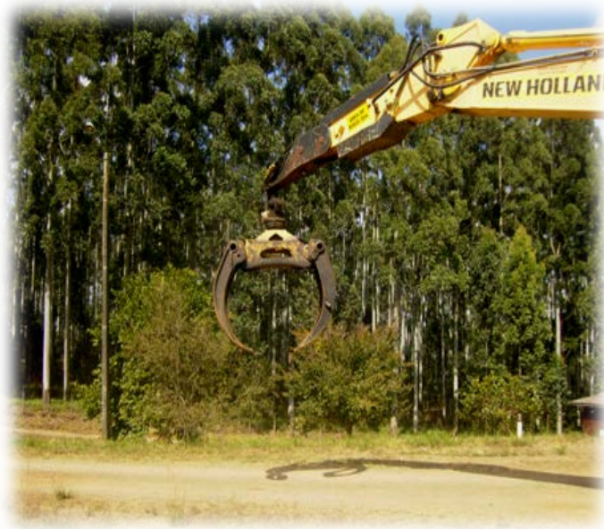
Figura 23: Garra suspensa sem necessidade.
