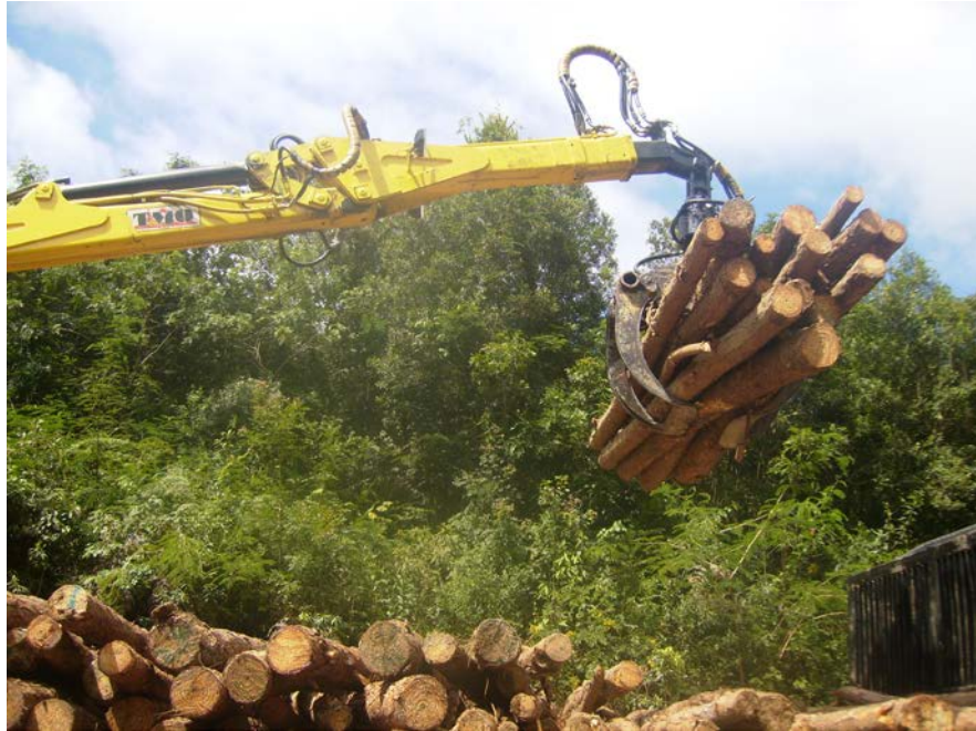
Figura 44: Uso do telescópio para posicionamento de carga.
