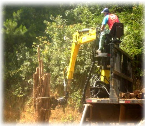
Figura 37: Procedimento inadequado da garra e rotator.
