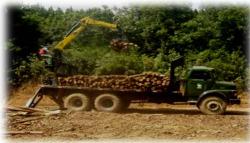
Figura 7: Grua acoplada em caminhão.
