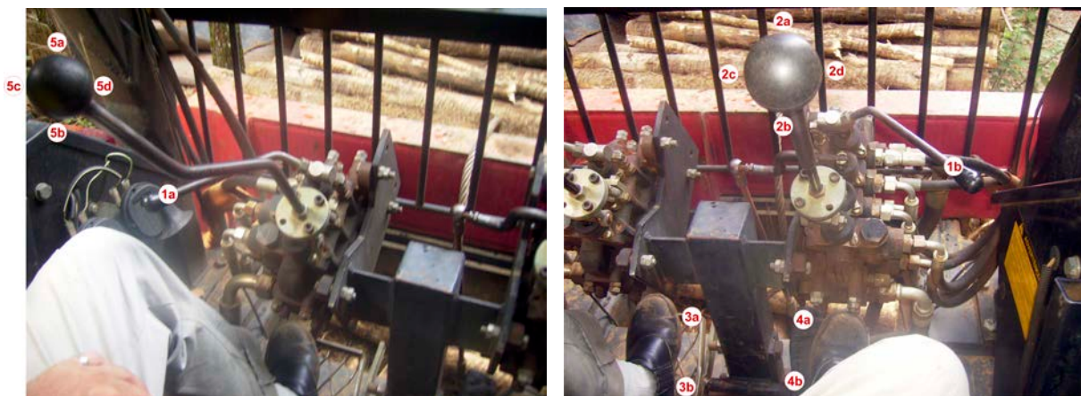
Figura 33: Comandos tipo joystick mecânico (esquerdo e direito) – equipamento Penzsaur.
