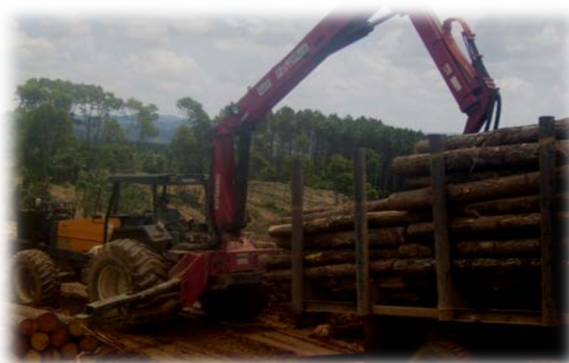
Figura 8: Grua acoplada em trator.
