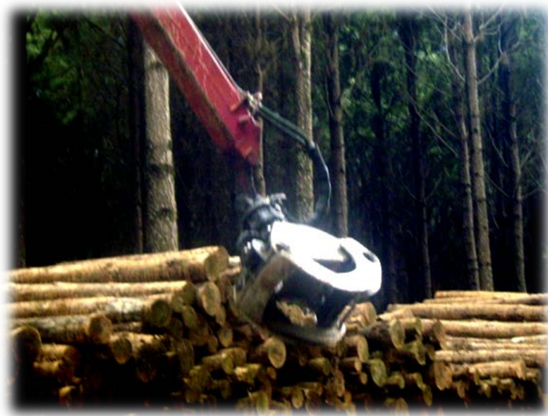
Figura 18: Colisão da garra com a pilha de madeira.
