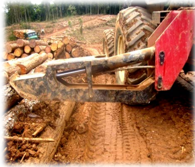
Figura 25: Sapatas sendo recolhidas.
