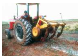
Escarificador de hastes para descompactação mecânica do solo
