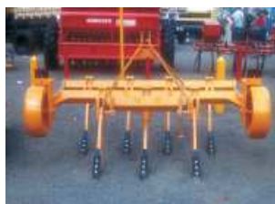
Escarificador de hastes para descompactação mecânica do solo
