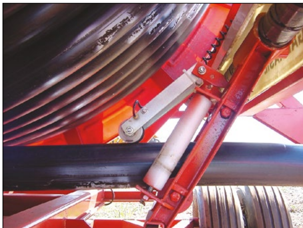
Rolete com sensor que regula a velocidade de enrolar da mangueira
