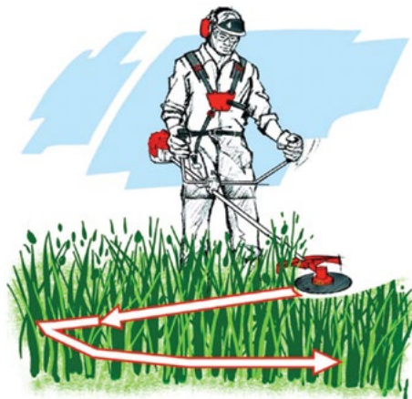
Figura 27: Corte indicado para relvas muito altas ou resistentes.
