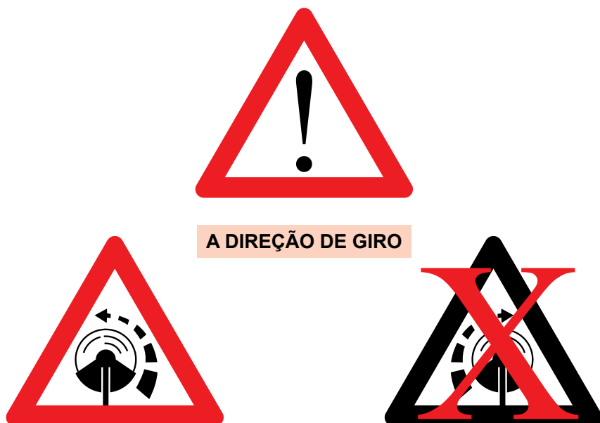
Figura 7: Direção de giro das ferramentas de corte de uma roçadeira (anti-horária).
