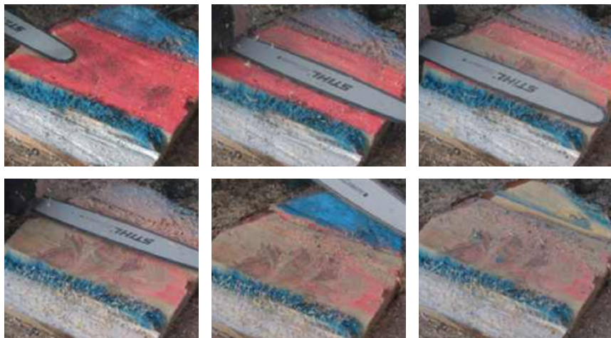
Figura 42 – Corte de segurança para árvores com menor inclinação ou quando há vento no sentido da queda (queda a favor da inclinação).
