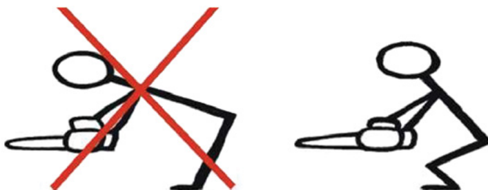
Figura 30 – Efeito alavanca: dobrar os joelhos evita sobrecarga na coluna.
