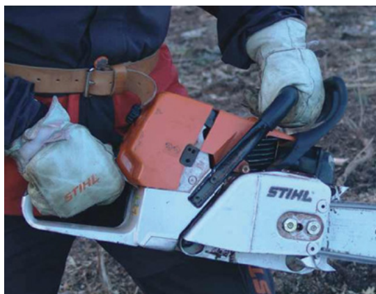
Figura 27 – Forma correta de segurar a motosserra.
