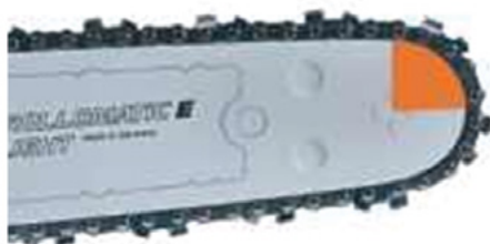
Figura 14 – Área do sabre (quarto superior da ponta) com maior risco de rebote.
