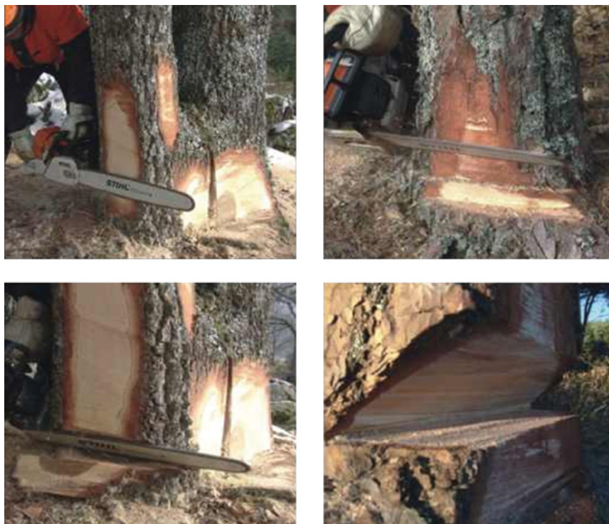
Figura 35 – Sequência do entalhe direcional.
