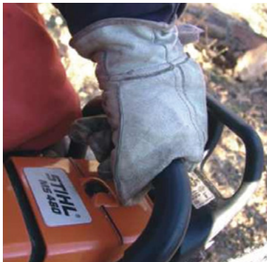
Figura 12 – Posição correta do dedo da mão esquerda (punho dianteiro).
