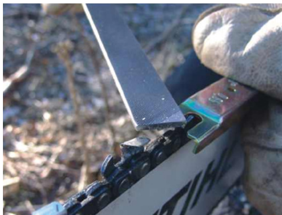
Figura 58 – Rebaixamento do limitador de profundidade com calibrador e lima chata.
