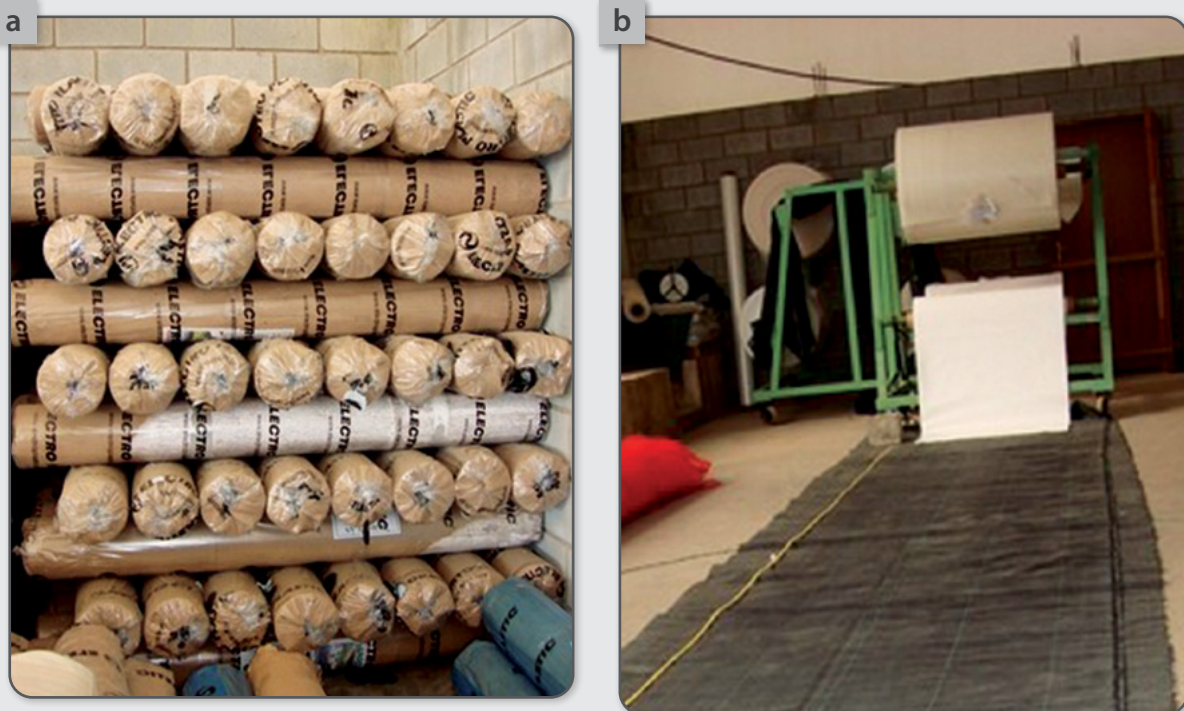
Figura 8 – Armazenamento de forma correta (a); proteção do local para corte (b).
