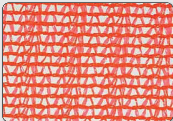
Figura 11 – Malha fotoconversora vermelha.
