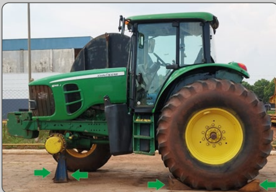
Figura 13 – Uso de calço e cavalete de segurança.
