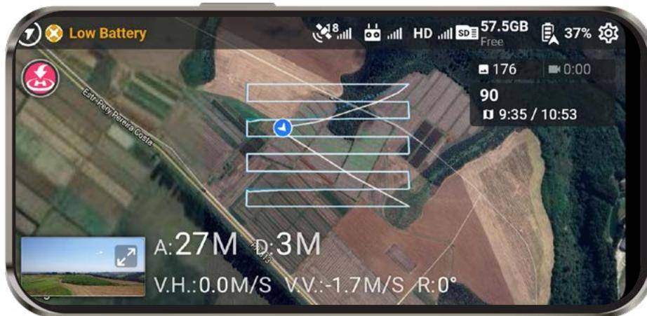
**Condições de tempo inadequadas para voo:** No exemplo acima, o equipamento não consegue manter a rota planejada. Caso o equipamento saia da área limite definida no plano de voo poderá ocorrer perda do equipamento devido ao vento ou falha no DroneDeploy. Neste caso cancele a missão.
