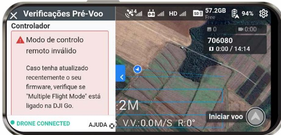
**Erro de configuração do controle:** Equipamento não decola devido a configuração errada de hardware. Reconfigure o controle.
