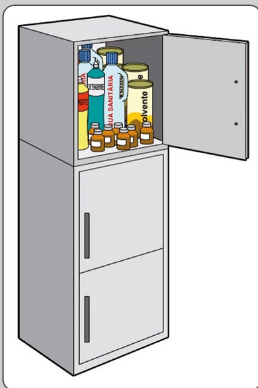
Figura 9 – Armário exclusivo para guardar produtos químicos.
