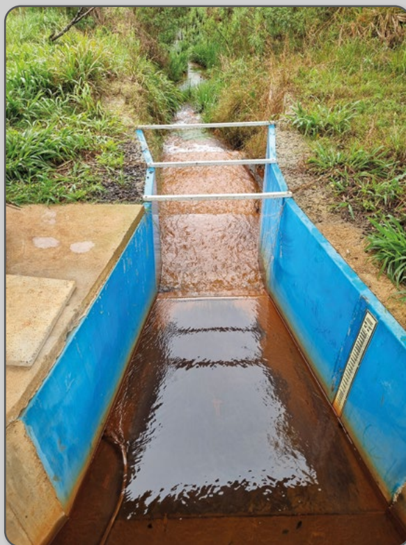
Figura 34 – Calhas Parshall para determinação da vazão e coleta de sedimentos.
