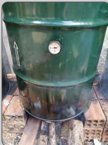
Figura 21 – Tambor metálico com controle de temperatura.
