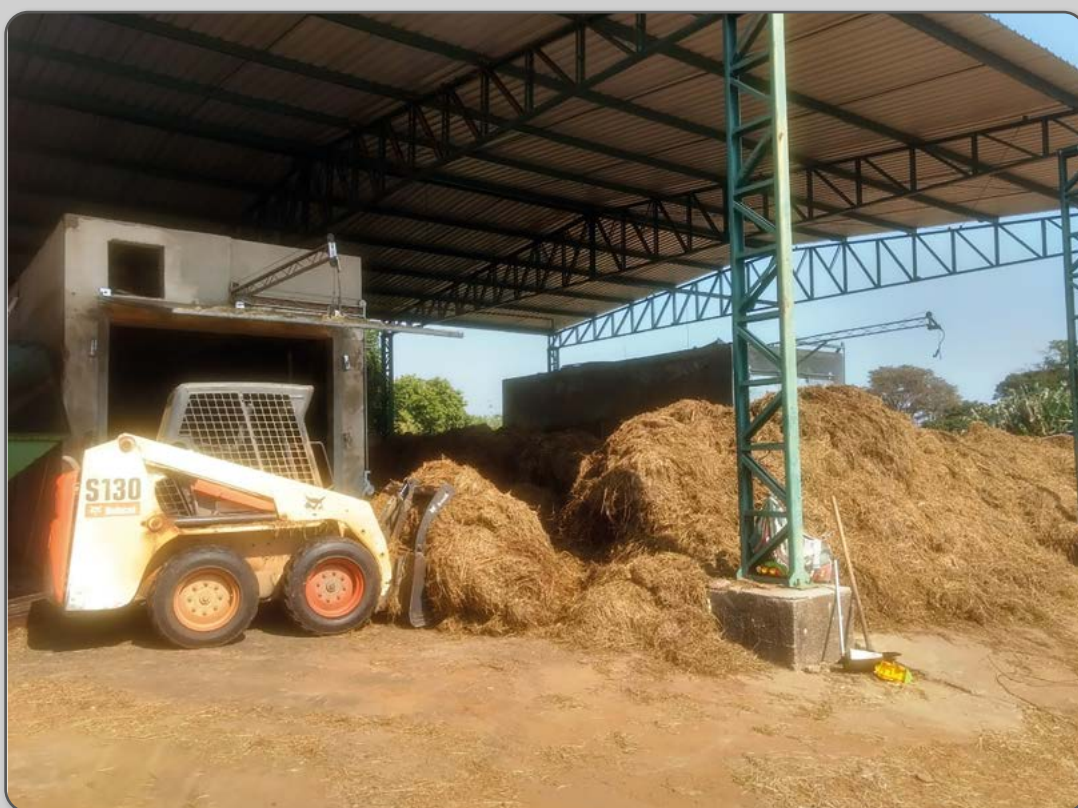
Figura 18 – Maquinário realizando o carregamento do substrato compostado para o interior do túnel de pasteurização.
