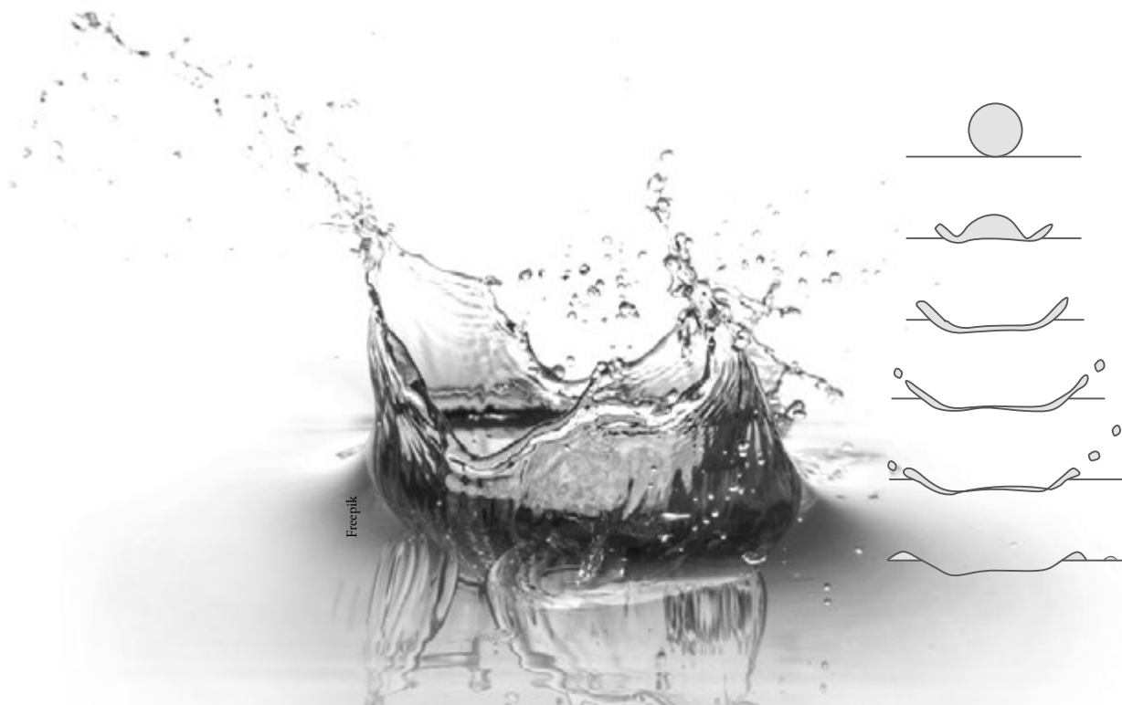
Figura 3 – Simulação do impacto da gota no solo.
