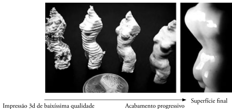
Figura 8 – Exemplo de técnicas de acabamento progressivas de objetos de impressão 3D sobre impressão 3D de baixíssima qualidade.
